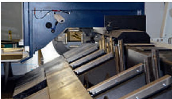
**Integrierte Kameras sorgen für die Überwachung des Schneidprozesses und der Handlingstätigkeiten.**
