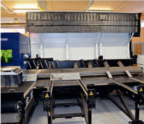
**Gute Zugänglichkeit: Die während des Schneidvorgangs vollgekapselte Entnahmestation kann nach oben weggeschwenkt werden.** (Bilder: TR)
